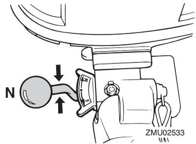
(2) Coloque la palanca de bloqueo de la elevación en la posición desenganchada.
