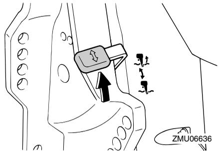
(3) Sujete con una mano la parte posterior de la capota superior, levante el motor y gire el soporte del motor elevado hacia usted o introduzca en el soporte de fijación la varilla de soporte del motor elevado y, a continuación, vuelva a colocar la palanca de bloqueo de la elevación en
