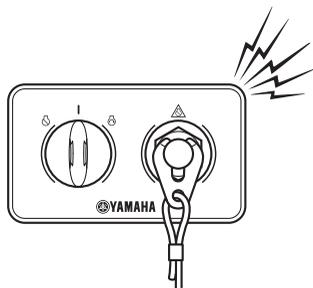
Si se activa el sistema de aviso, pare el motor y compruebe si están obstruidas las entradas de agua de refrigeración.
