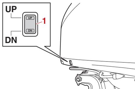
1. Interruptor de elevación y trimado del motor
