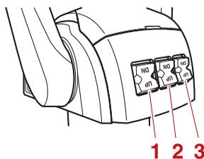
1. Interruptor de elevación y trimado del motor (motor de estribor)
