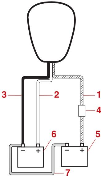
1. Conductores aislantes con protección de circuitos
