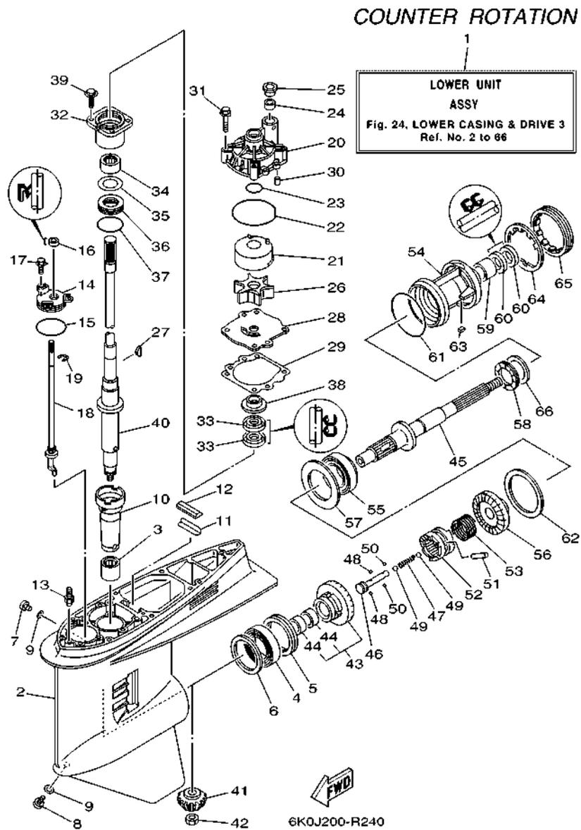
**FIG. 24 LOWER CASING & DRIVE 3**
