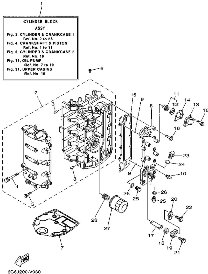
**FIG. 3 CYLINDER & CRANKCASE 1**
