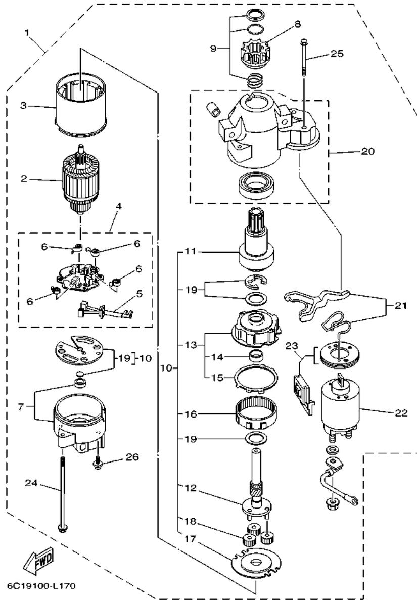
FIG. 18 STARTING MOTOR
