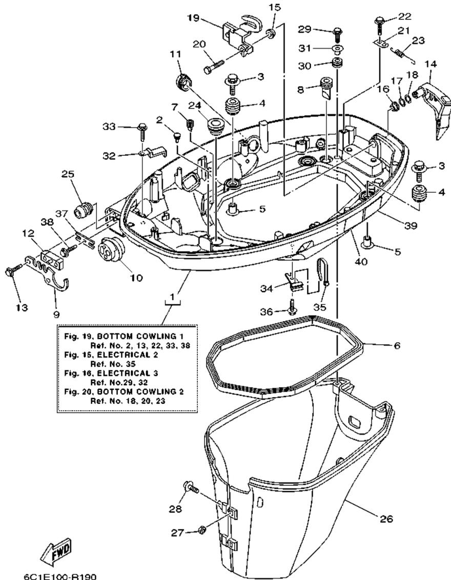
FIG. 19 BOTTOM COWLING 1
